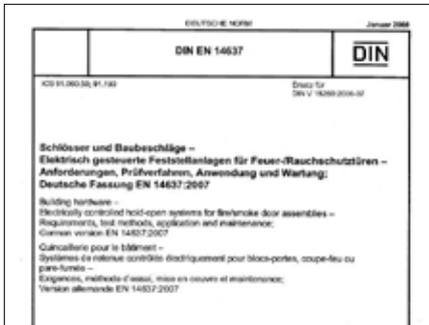
En raison de leur grande importance pour la protection contre l'incendie, les systèmes de blocage sont réglementés au niveau européen par la norme EN 14637 : Quincaillerie pour le bâtiment - Système de retenue contrôlé électriquement pour blocs-portes, coupe feu ou pare-fumée - Exigences, méthode d'essai, mise en œuvre et maintenance.
